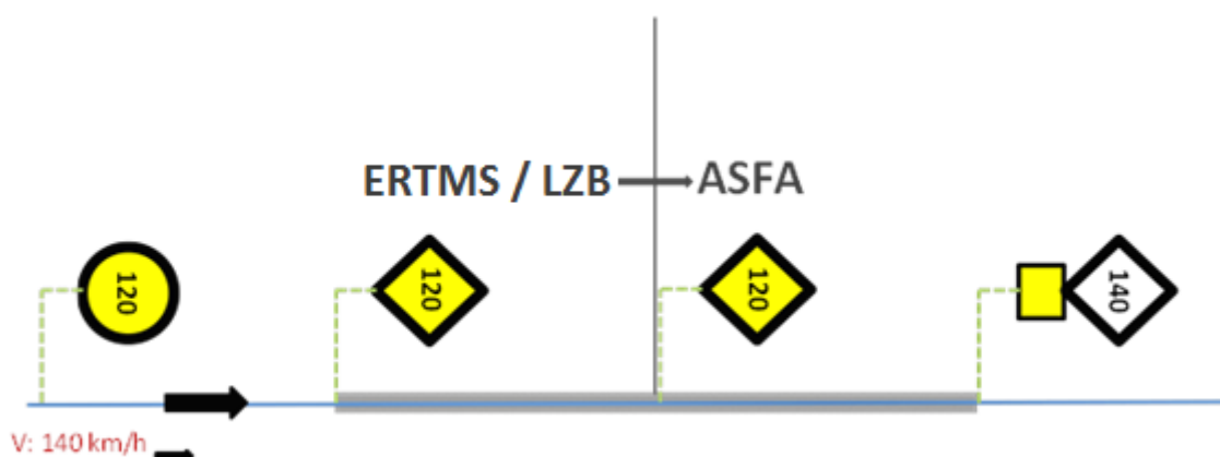
Figura 51. Señalización LTV antes del punto de transición ERTMS o LZB a ASFA. No existe cambio significativo de velocidad.
