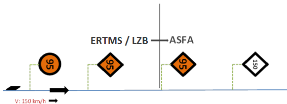
Figura 26. Señalización de cambio de velocidad máxima antes del punto de transición ERTMS o LZB a ASFA. Existe cambio significativo de velocidad.
