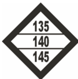
Figura 5. Ejemplo de señal fija de final de limitación temporal de velocidad máxima
