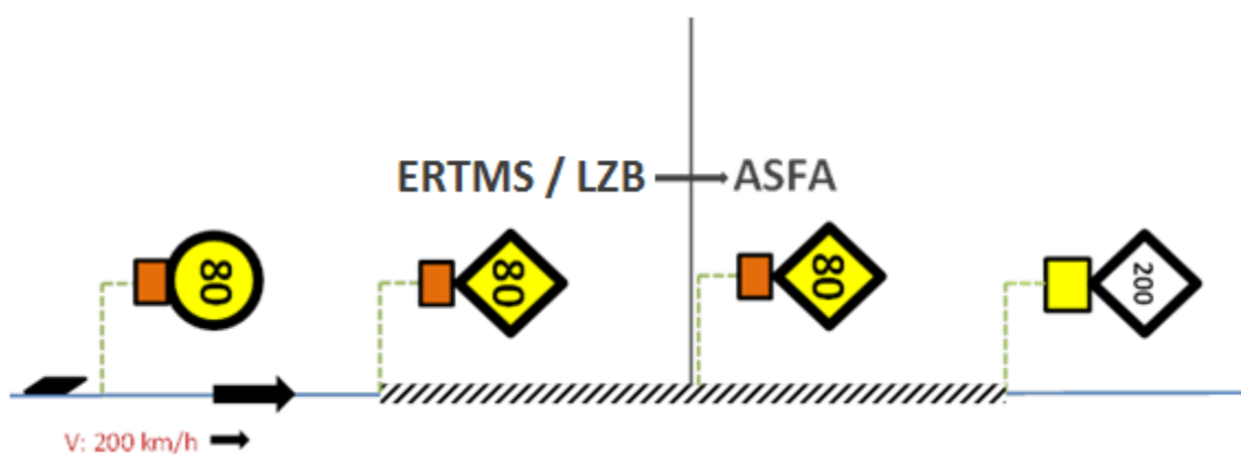
Figura 52. Señalización LTV antes del punto de transición ERTMS o LZB a ASFA. Existe cambio significativo de velocidad.
