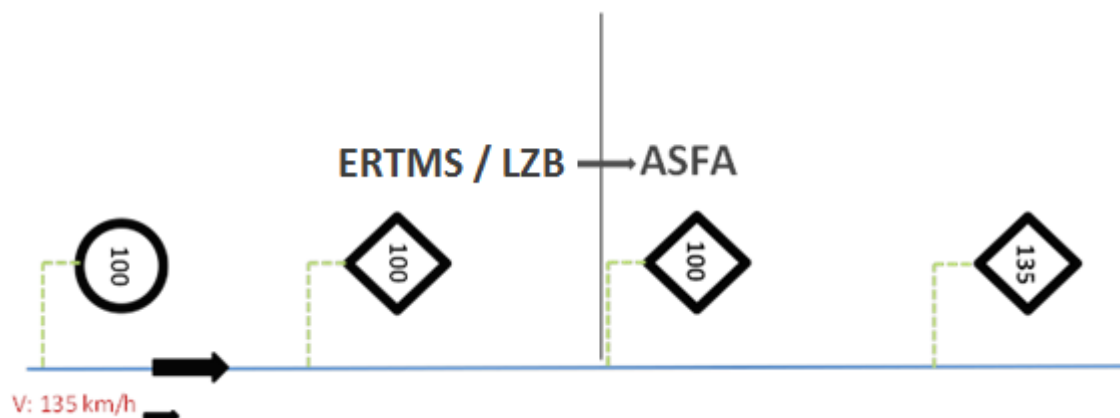
Figura 25. Señalización de cambio de velocidad máxima antes del punto de transición ERTMS o LZB a ASFA. No existe cambio significativo de velocidad.
